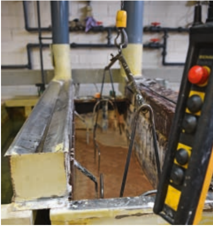
Heiß und ätzend: Die Arbeit an der Tauchbrüniermaschine erfordert trotz modernster Technik große Achtsamkeit.
